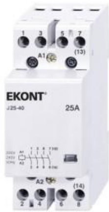
Installationsschütz 25A 4- pol., 4 Schliesser, 230V
